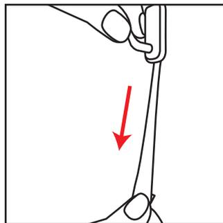
荷重は垂直（真下）方向にかかるようにしてください。水平方向に荷重がかかると落下する恐れがあります。掛けるものの形状がフックの形状に合わない場合は、フックに無理な力が加わり落下する可能性があります。
